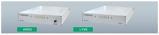
ARIES/LYNXはMotionnetを採用してARIES(2軸マスターコントローラ)1台に対して、LYNX(2軸スレーブコントローラ)を 最大15台接続することで、32軸までの制御を実現しました。
